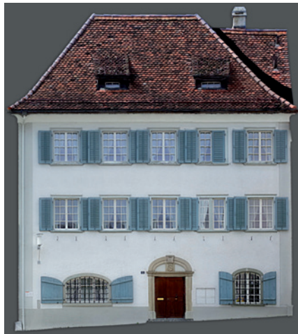
Masstäblicher, entzerrter Fassadenplan mit Fototexturierung
