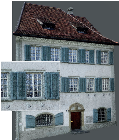
Schrägansicht der Punktwolke aus der Auswertung mit Detailansicht
