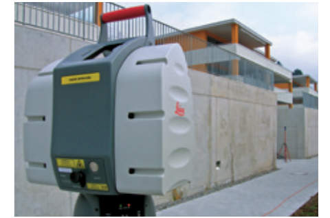
Unser 3D-Laserscanner Leica HDS 3000 beim Scannen der deformierten Mauer
