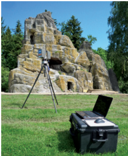
3D-Laserscanner bei der Aufnahme des Felsens
